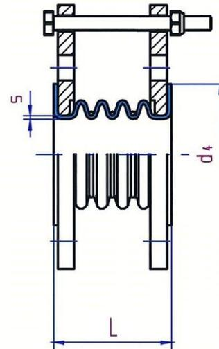
Zur Gewährleistung einer einwandfreien Montage sind unsere Kompensatoren mit 3 Begrenzungsschrauben versehen. Sie verhindern, dass der Balg im Betrieb überstreckt werden kann.
